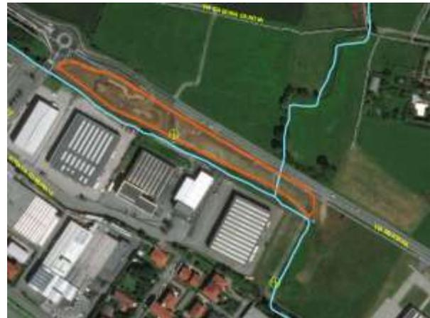
Figura 26 - Opere idrauliche realizzate (in rosso l'area golenale; in verde le griglie)
