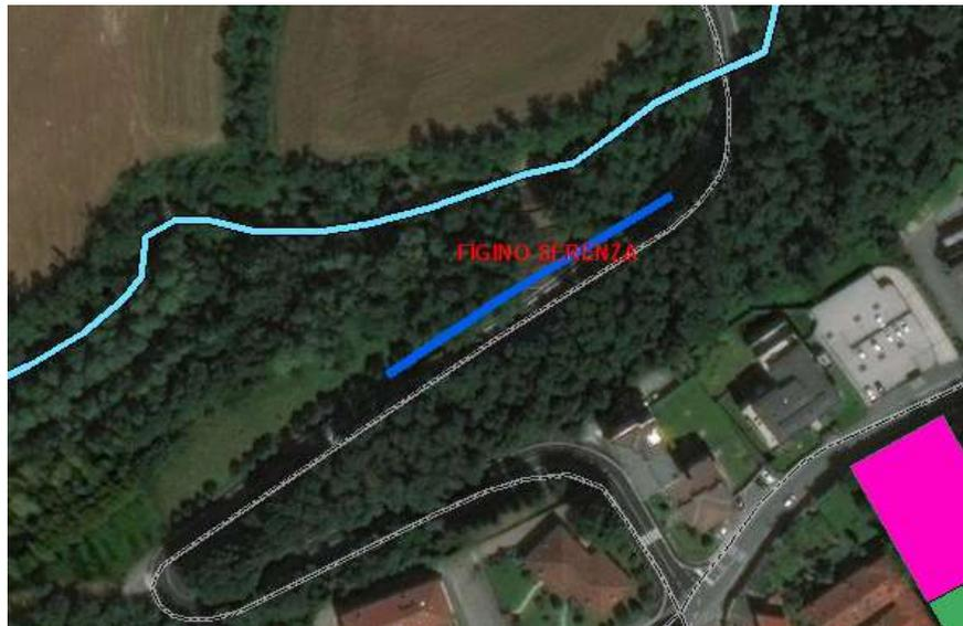
Figura 31 - Cedimento scarpata stradale per erosione del Torrente Serenza (in blu)
